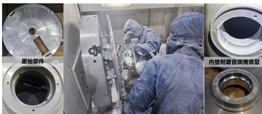
图 2 电力装备铝合金端盖轴套内壁耐磨自润滑涂层制备现场
