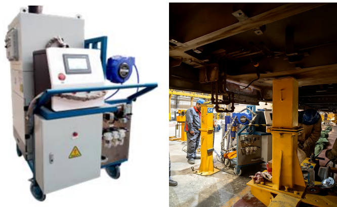
图 1 移动式超音速冷喷涂设备及高铁车体修复现场
